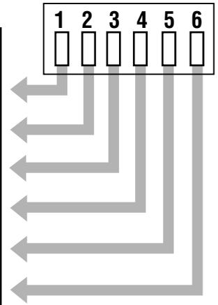
• Para habilitar la prealarma, debe colocarse el jumper Nº 1. Para deshabilitar la prealarma se debe remover dicho jumper.
